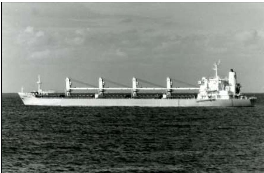
**figure 18** : Le vraquier BENGUERIR (1984–1993) ; 22 076 tx de jauge brute, longueur 187,7 m ; construit au Japon (Aioi) en 1984 ; ici en rade de Tanger en 1987 ; photo : Piotr Kment.
