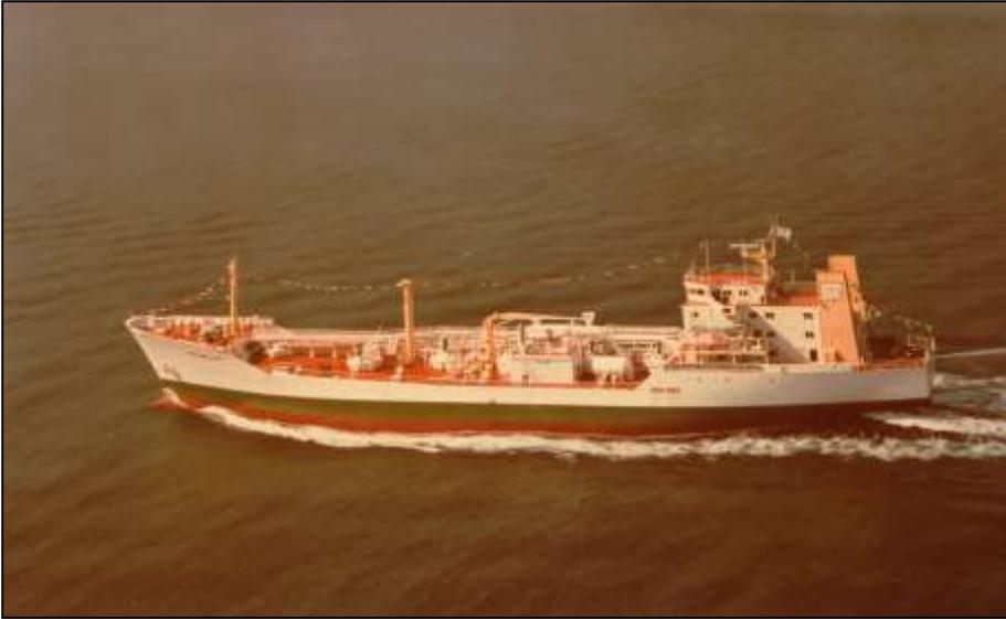
**figure 7** : Le navire citerne butanier AL GHASSANI (1977–1984) ; 4 058 tx de jauge brute, longueur 102,1 m ; construit en Norvège (Ulsteinvik) en 1977 ; spécialisé dans le transport de gaz de pétrole liquéfié (GPL) ; ici, à Rotterdam (Hollande) en 1980 ; photo : Pieter Melissen.
