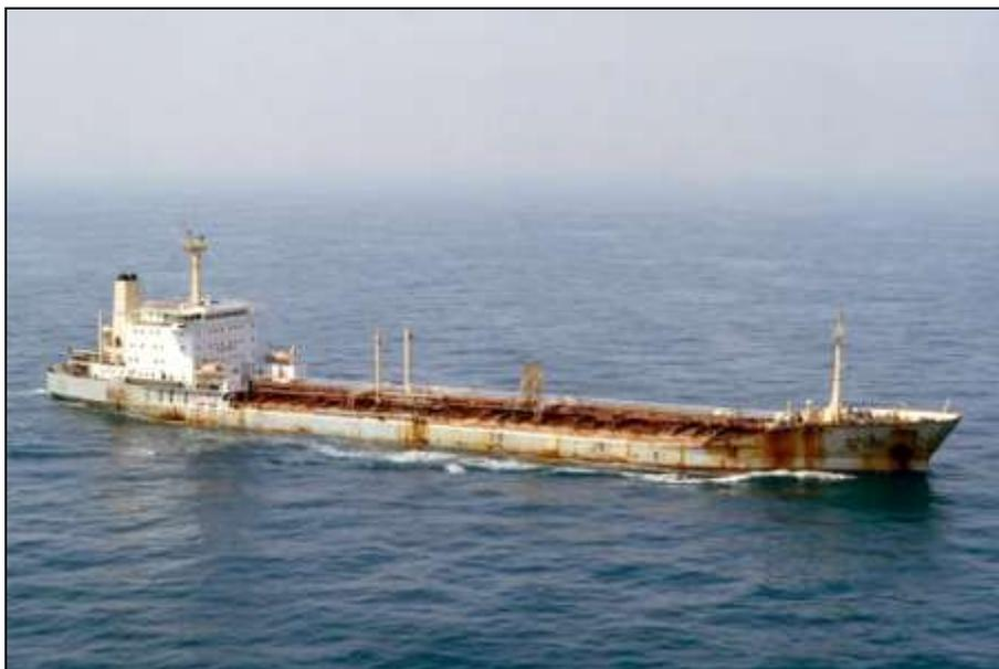
**figure 9** : Le navire chimiquier IBN ROCHD (1977–1994) ; jauge brute 7 178 tx, longueur 144,5 m, largeur 18 m, tirant d'eau 8,29 m, port en lourd 9 138 tonnes, puissance 12 000 cv, vitesse 18,5 nœuds ; construit en Hollande (Lobith) en 1977 ; ici en 1990 ; *photo* : Yvon Perchoc.
