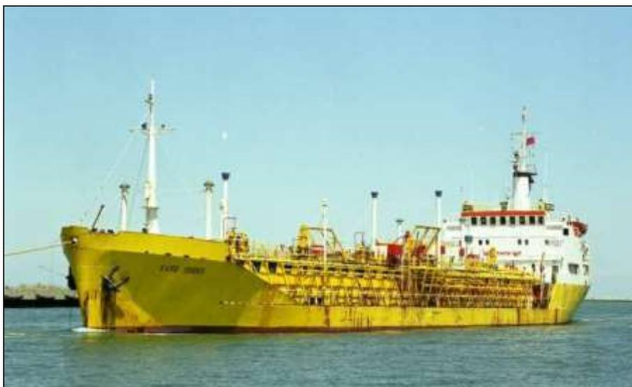
**figure 10** : Le navire citerne TAFILALET (1977–1982) ; 2 345 tx de jauge brute, longueur 97,3 m ; construit en Finlande (Savonlinna) en 1975 ; spécialisé dans le gaz de pétrole liquéfié (GPL) ; ici, sous le nom CAPO CERVO, entrant à Ravenne le 1er juin 2001 ; *photo* : Malcolm Cranfield.
